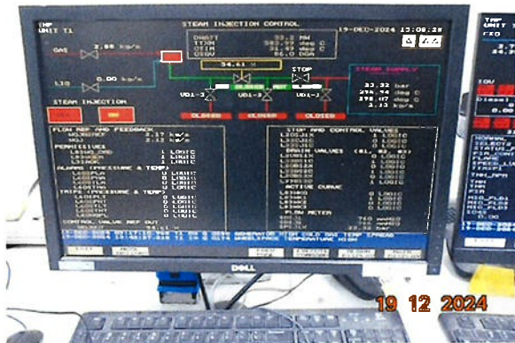
ภาพที่ 2.2-6 หน้าจอควบคุม NOx โดยใช้ steam injection system
