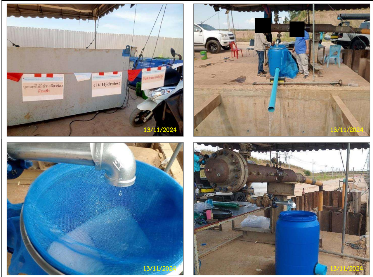
รูปที่ 2-34 การทดสอบท่อด้วยวิธีทางชลสถิต
