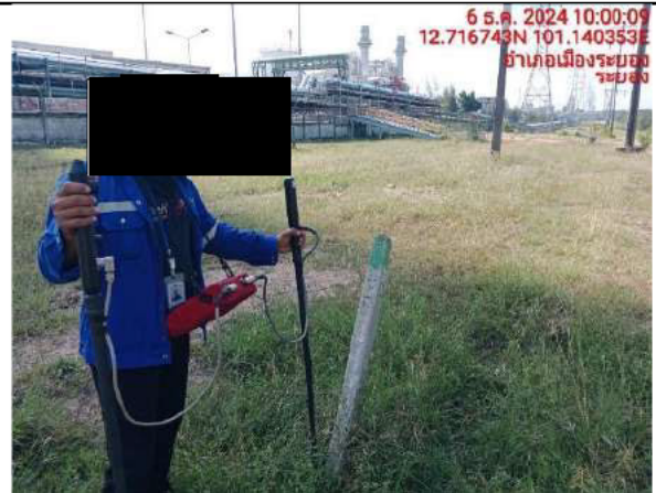
รูปที่ 2-12 การตรวจสอบแนวท่อด้วยวิธี DCVG ที่ดำเนินการล่าสุด
