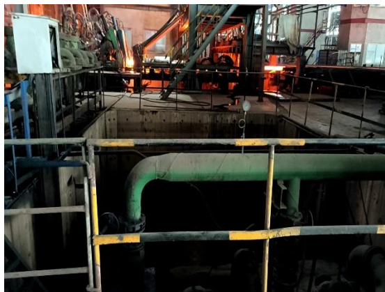
ภาพถ่ายที่ 2.2-12 บ่อรับน้ำที่ผ่านการหล่อเย็นบริเวณใต้เครื่องหล่อเหล็ก
