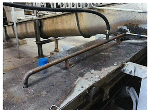
ภาพที่ 2-60 หัวสเปรย์น้ำสายพานลำเลียงเก่า
