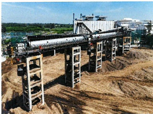
ภาพที่ 2-8 ระบบปิดครอบสายพานลำเลียงกากอ้อย
