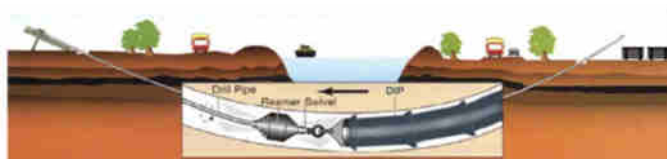
การดึงท่อกลับ (Pipeline-Pullback)
