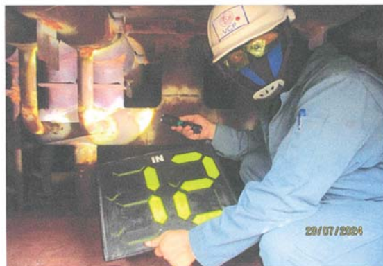
ตรวจสอบสภาพท่อน้ำ ด้าน HP Part หลังทำHydrostatic Test ผลปกติไม่มีการรั่วใดๆ หม้อไอน้ำหมายเลข 2( HRS-12 ) บริษัท ราชบุรีเวิลด์ โคเจนเนอเรชั่น จำกัด วันที่ 20 กรกฎาคม 2567
