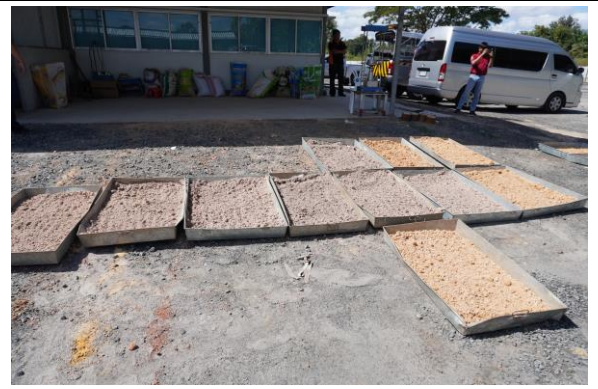
รูปที่ 3.1-2 การทดสอบความเสถียรของดิน
