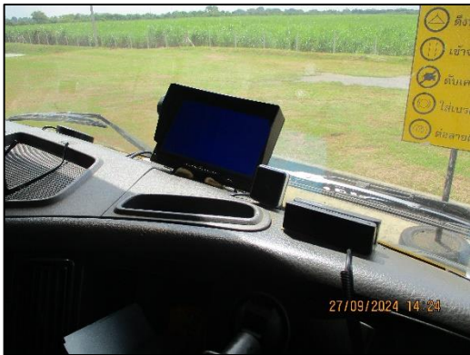
ภาพถ่ายที่ 2.2-13 รถบรรทุกน้ำมันซึ่งติดตั้งอุปกรณ์ระบุตำแหน่งด้วยดาวเทียม (GPS)
