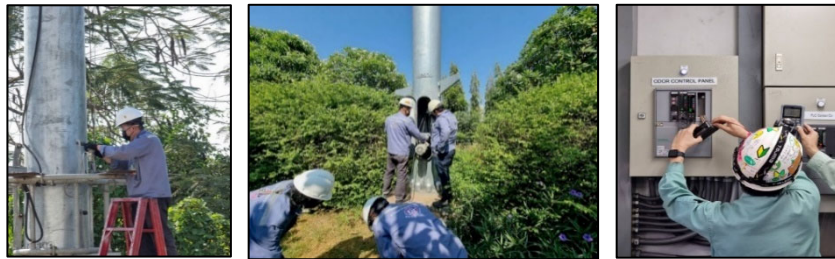
ภาพที่ 2.52 การสอบเทียบและบำรุงรักษาเครื่องวัดคลื่น
