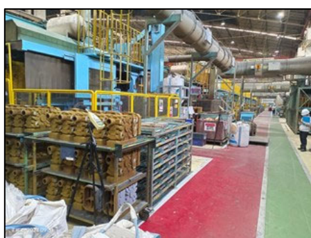
ภาพที่ 3.17.2 ภาพแสดงการตรวจวัดระดับเสียงในพื้นที่ทำงานเพื่อจัดทำ Noise contour map
