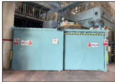
ภาพที่ 2.9 ห้องครอบเสียงเครื่องขัดชิ้นงานอัตโนมัติ และห้องครอบเสียงกระบะกั้น
