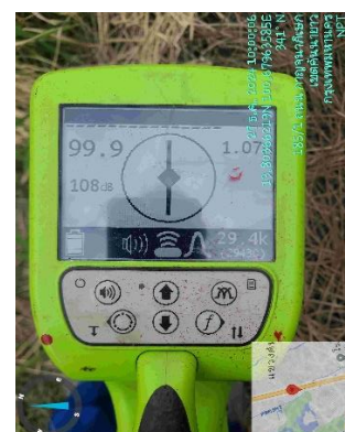
ภาพแสดงอุปกรณ์วัดความลึก ขณะตรวจสอบแนวท่อส่งน้ำมัน
