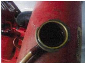
ตรวจสอบระดับน้ำหม้อน้ำ
