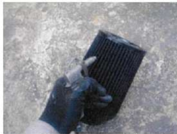
ทำความสะอาดหรือเปลี่ยน (Adhoc) ไส้กรองอากาศ
