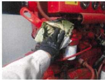
สตาร์ทเครื่องและตรวจสอบการรั่วซึมของน้ำมันเครื่อง
