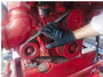
ตรวจสอบความตึงและการสึกหรอของสายพานหัดลม
