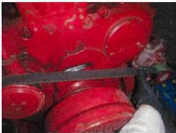
ตรวจสอบความตึงและการสึกหรอของสายพานพัดลม
