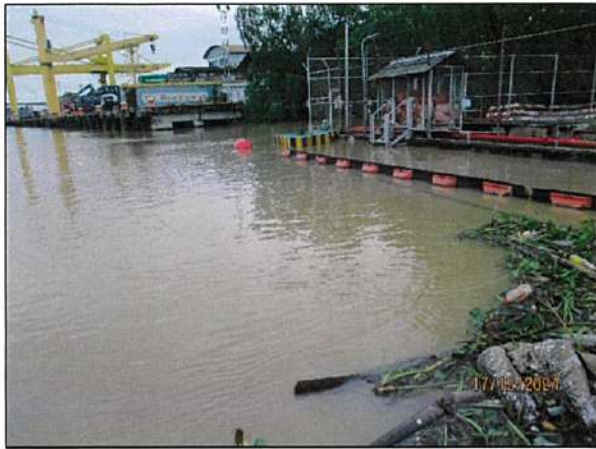
ภาพถ่ายที่ 2.2-17 พุน้ำกักเก็บคราบน้ำมันบริเวณท่าเทียบเรือ
