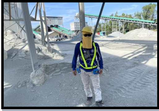
รูปที่ 2-14 การตรวจวัดฝุ่นละอองพนักงานโรงโม่หิน
