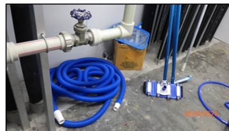
รูปที่ 2.53 อุปกรณ์ เครื่องมือสำหรับใช้ทำความสะอาดสระว่ายน้ำ
