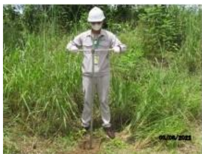
ขุดเจาะดินด้วย Soil Auger (ความลึกดิน 50 ซม.)
