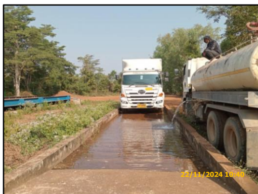
ภาพที่ 2.7 บ่อล้างล้อรถบรรทุกที่ขนส่งแร่
