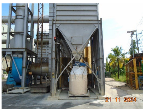
ภาพที่ 2-3 ระบบตักฝุ่นแบบถุงกรอง
