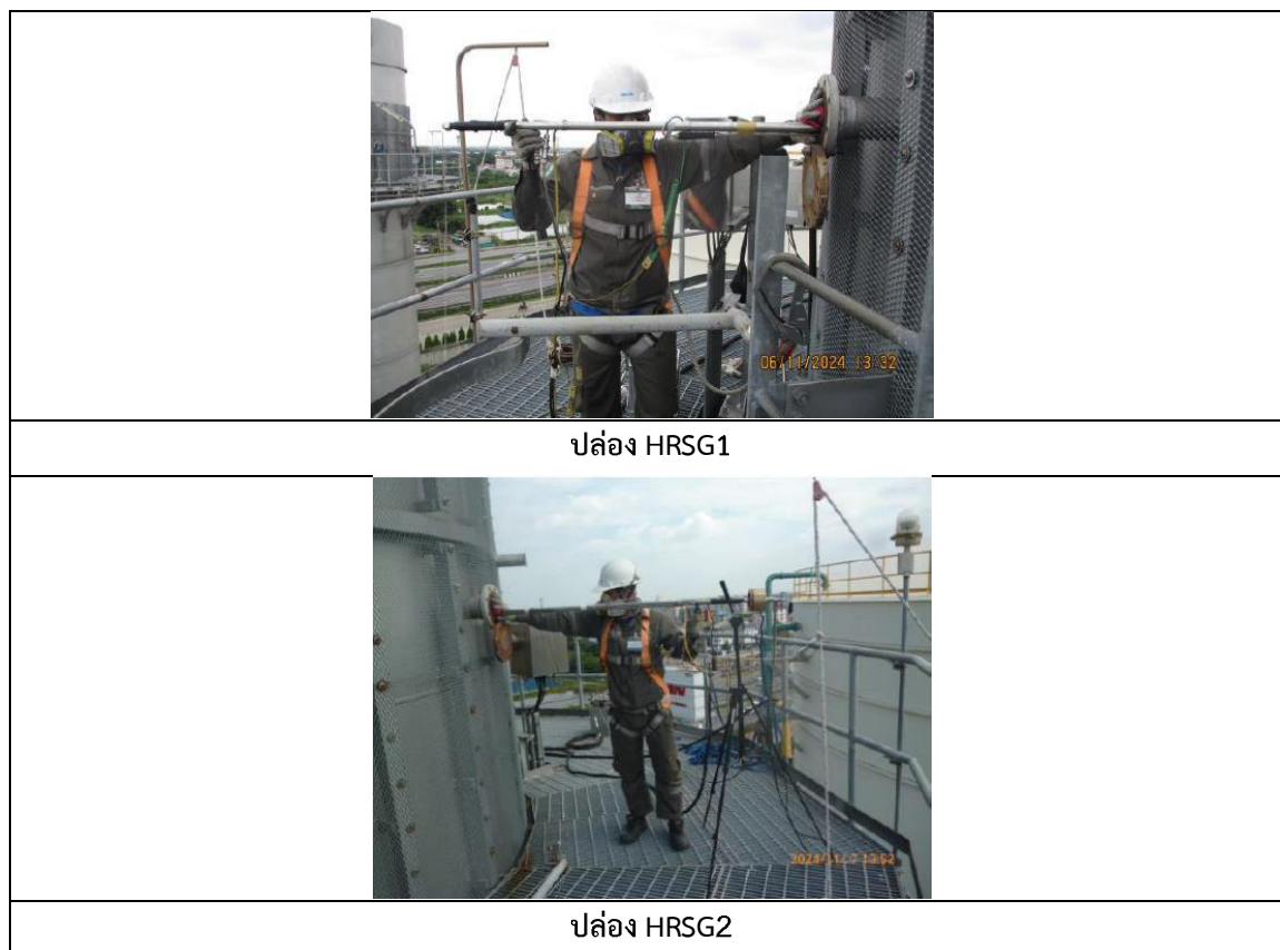
รูปที่ 3.2-3 : การเก็บตัวอย่างอากาศจากปล่องระบาย HRSG1 และปล่อง HRSG2 ของโครงการ เมื่อวันที่ 6-7 พฤศจิกายน 2567
