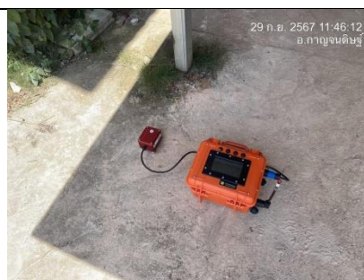
รูป AE ตรวจวัดแรงสั่นสะเทือน และแรงอัด อากาศจากการใช้วัตุระเบิดของโครงการจำนวน 2 สถานี
