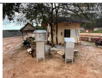
รูป AB ตรวจวัดปริมาณฝุ่นละอองแขวนลอยในบรรยากาศ TSP และ PM10 เฉลี่ยในรอบ 24 ชั่วโมงเป็นเวลา 3 วัน ต่อเนื่อง โดยใช้เครื่อง High Volume Air Sampler จำนวน 4 สถานี
