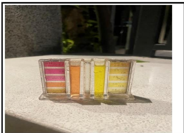
รูปที่ 3.24 ตรวจสอบความเป็นกรดต่างของสระว่ายน้ำเป็นประจำ
