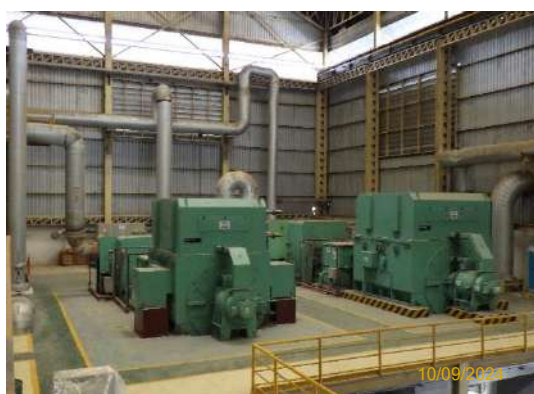
รูปที่ 2-27 การปิดครอบเครื่องจักรอุปกรณ์ที่มีเสียงดัง
