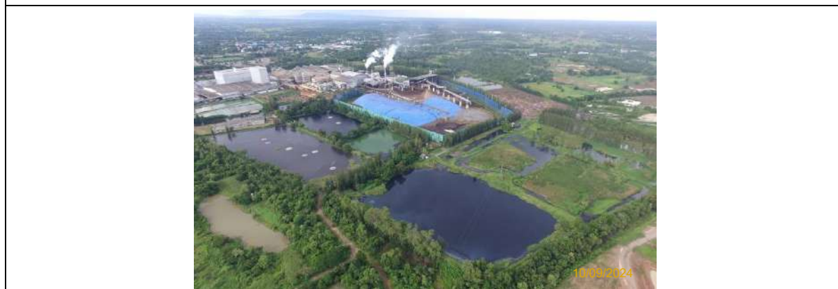
รูปที่ 2-30 ระบบบำบัดน้ำเสียของโครงการ ขนาด 1,800 ลูกบาศก์เมตร/วัน
