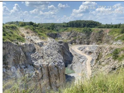
รูป B บ่อดักตะกอนบริเวณหน้าเหมือง (Sump)
