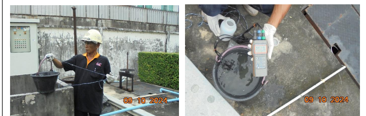
รูปที่ 3-2 การเก็บตัวอย่างน้ำผิวดินแหล่งรองรับน้ำทิ้งจากโครงการ
