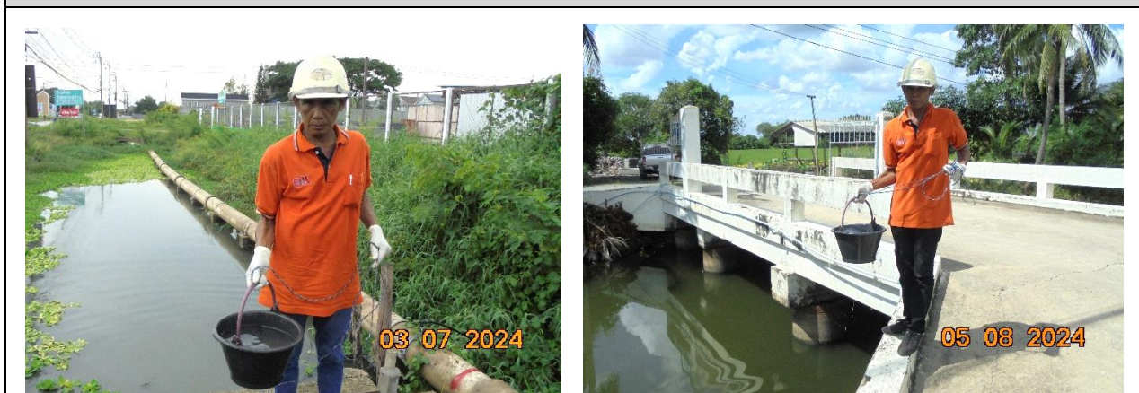
รูปที่ 3-2 การเก็บตัวอย่างน้ำผิวดินแหล่งรองรับน้ำทิ้งจากโครงการ
