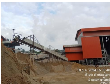
รูป Q การติดตั้งอุปกรณ์ปิดคลุมโดยตลอดพร้อมทั้งติดตั้งเครื่องฉีดสเปรย์น้ำ
