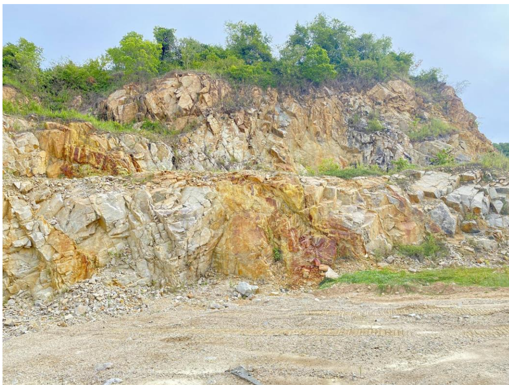
ภาพที่ 1 เปิดหน้าเหมืองเป็นแบบขั้นบันได รักษาระดับความสูงและความกว้าง ของขั้นบันไดตามเกณฑ์ที่ทางราชการกำหนด
