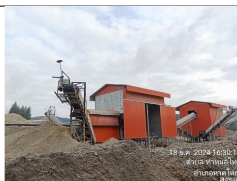
รูป P การปิดคลุม เครื่องบด ชุดตะแกรง สายพานและสเปรย์น้ำ
