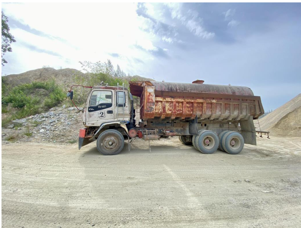
ภาพที่ 4 ใช้รถบรรทุกน้ำฉีดพรมตามแนวถนนจากหน้าเหมืองถึงโรงโม่หิน
