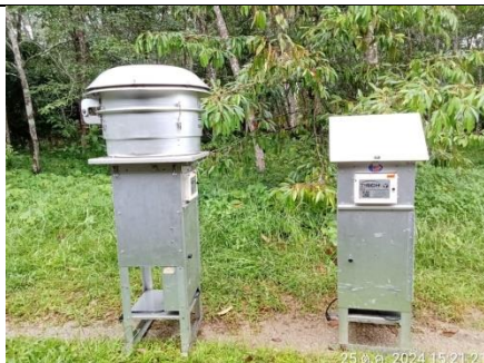
รูป AP ตรวจวัดปริมาณฝุ่นละอองรวม (TSP) และปริมาณ ฝุ่นละอองขนาดเล็กไม่เกิน 10 ไมครอน (PM10) จำนวน 2 สถานี
