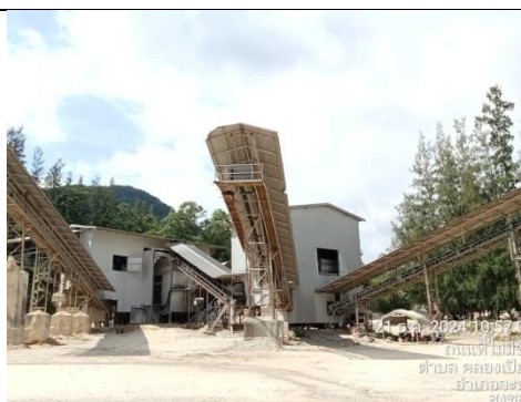
รูป P การปิดคลุม เครื่องบดชุดที่ 1 และ 2 และชุดตะแกรง
