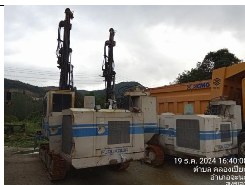
รูป V รถเจาะหินที่ติดตั้งเครื่องดูดฝุ่น
