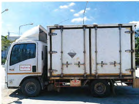
ภาพที่ 2.2-45 การติดเครื่องหมายฉลากและป้ายบนรถ ขนส่งสารเคมี
