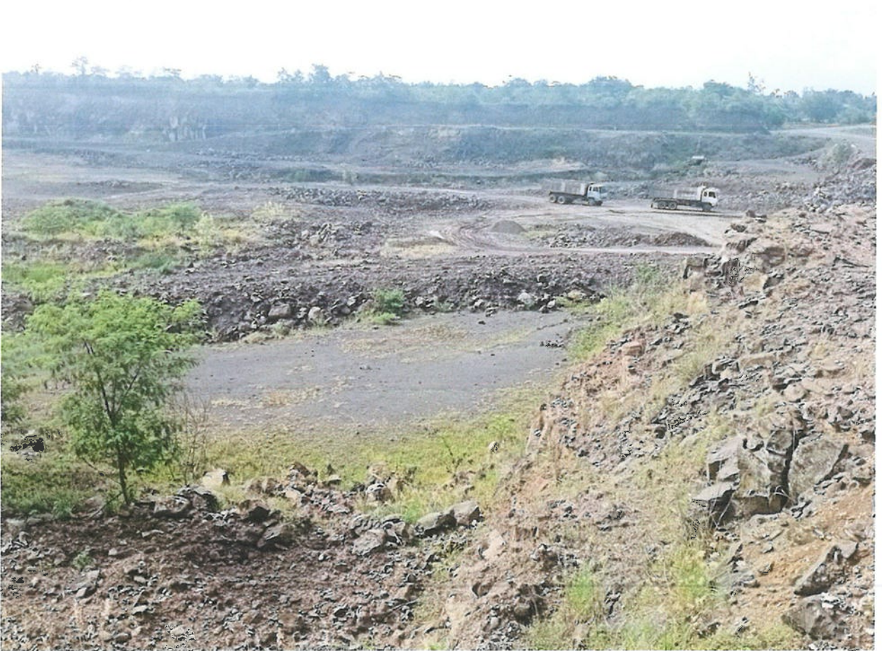
รูปที่ 2 ทำเหมืองแบบชันบันได
