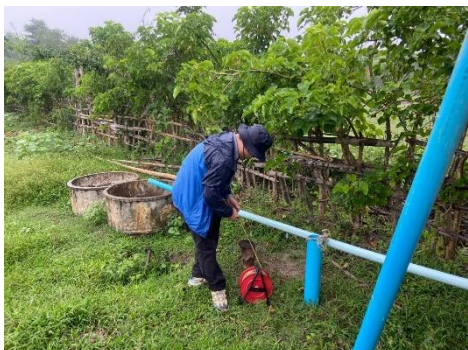
วัดระดับน้ำใต้ดินบ่อบาดาล (PP04) หลังวัดห้วยแม่ป่าไผ่ใกล้กับห้วยแม่ป่าไผ่
