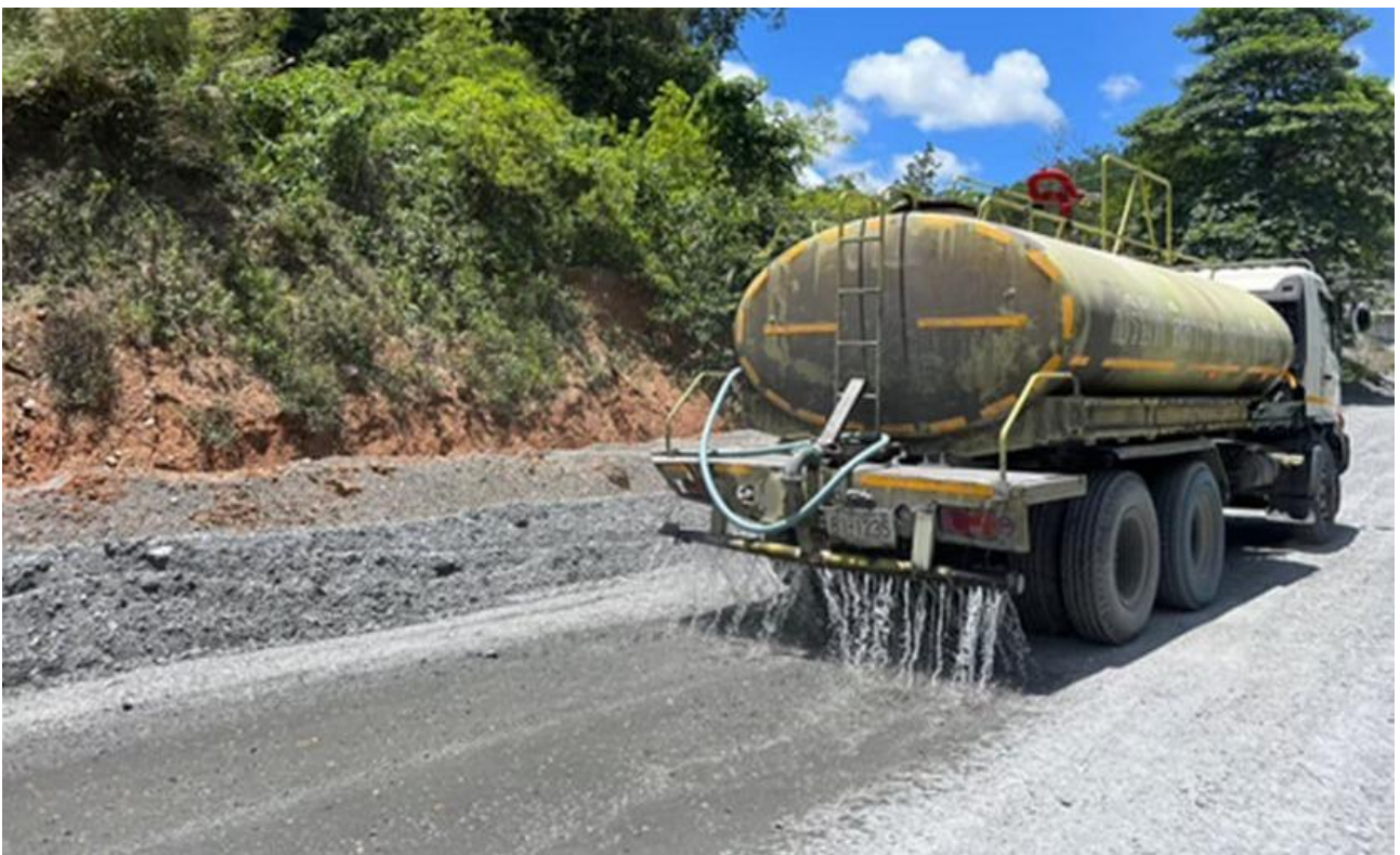
รูปที่ 1-36 : รถบรรทุกน้ำฉีดราดตามถนนในเขตเมืองแร่
