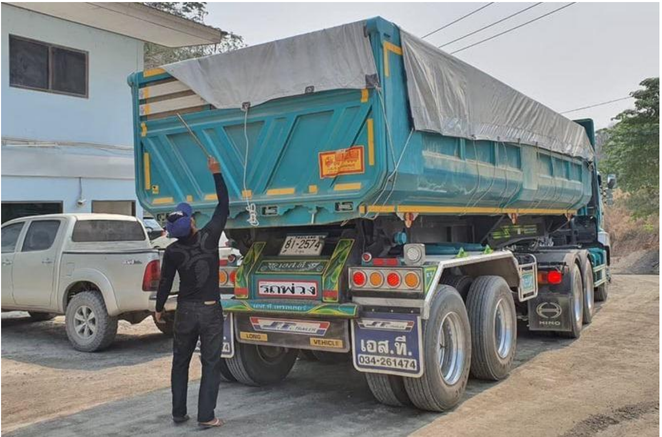
รูปที่ 1-35 : การปิดคลุมรถบรรทุกหิน ก่อนออกจากโรงโม่หิน
