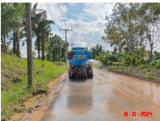
รูปที่ 9 การฉีดพรมน้ำบริเวณหน้าเหมืองและเส้นทางขนส่งแร่
