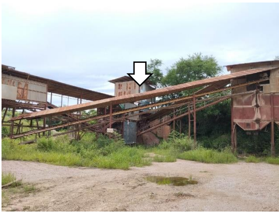
รูปที่ 9 หลังคาปิดคลุมสายพานลำเลียง
