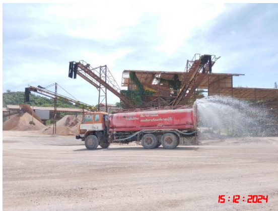
รูปที่ 13 ระบบป้องกันผลกระทบสิ่งแวดล้อมบริเวณโรงโม่หิน
