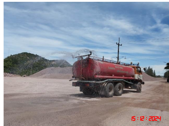
รูปที่ 13 ระบบป้องกันผลกระทบสิ่งแวดล้อมบริเวณโรงโม่หิน
