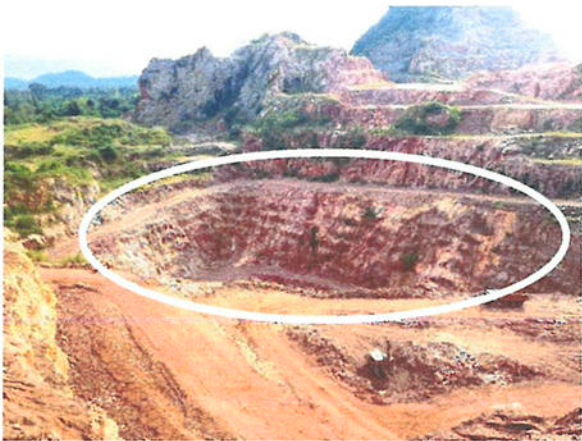
รูปที่ 2 การเปิดหน้าเหมืองเป็นชั้นบันได
