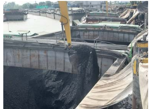
รูปที่ 2-25 ภาพถ่ายการจอดเรือหน้าท่าขณะขนถ่ายสินค้า (ไม่จอดเรือซ้อนลำ)
