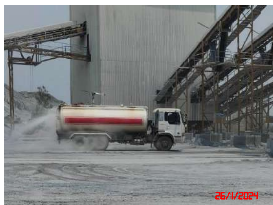
รูปที่ 11 การฉีดพรมน้ำบนเส้นทางขนส่งแร่
