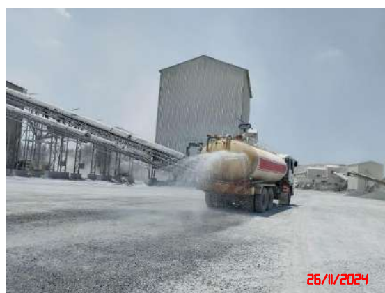
รูปที่ 11 การฉีดพรมน้ำบนเส้นทางขนส่งแร่
