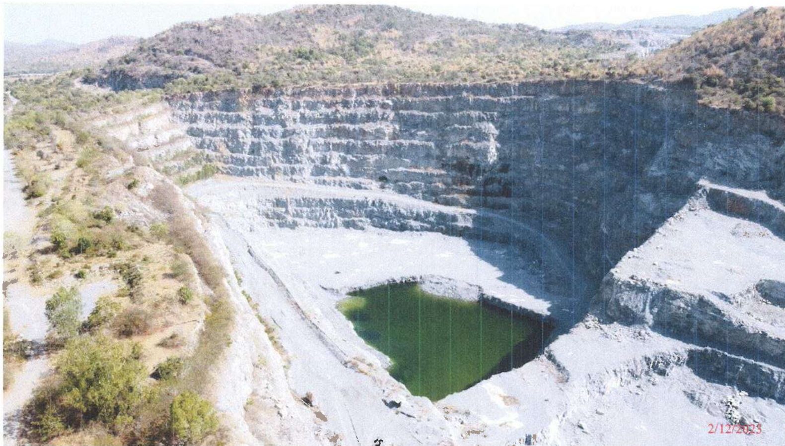
ภาพ ที่ 10 : บ่อพักน้ำคักตะกอนบริเวณที่พื้นที่ต่ำสุดของหน้าเหมืองภายในพื้นที่โครงการ
