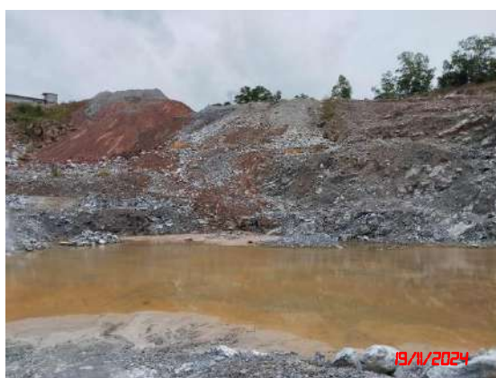
รูปที่ 26 บ่อรับน้ำ (Sump)
