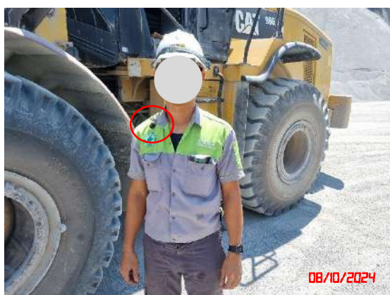
รูปที่ 27 การตรวจวัดระดับความดังเสียง (Noise Dose) เมื่อวันที่ 8 ตุลาคม 2567
