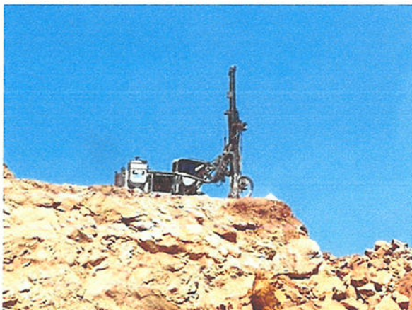
รูปที่ 3 เครื่องเจาะหินพร้อมระบบดูดฝุ่น
