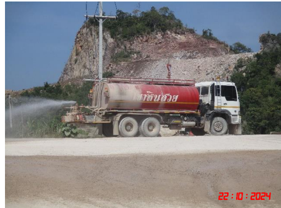
รูปที่ 10 การเก็บกวาดฝุ่นละอองที่ตกค้างสะสมบริเวณพื้นที่โรงโม่หินและเส้นทางลำเลียงแร่
