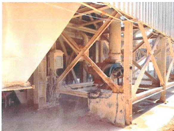
รูปที่ 19 ติดตั้งและใช้งานระบบดูดฝุ่นละออง ขณะโม่หินแบบ Bag Filter บริเวณ Secondary & Tertiary Crusher
