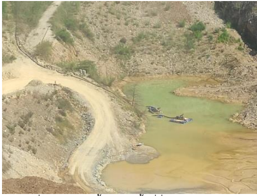
รูปที่ 2-18 บ่อรับน้ำบริเวณพื้นที่ต่ำสุดของบ่อเหมือง
