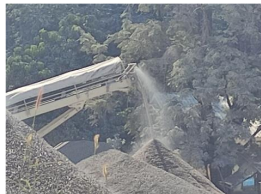
รูปที่ 2-7 (ต่อ) การสเปรย์น้ำที่ปลายสายพานลำเลียงหิน
