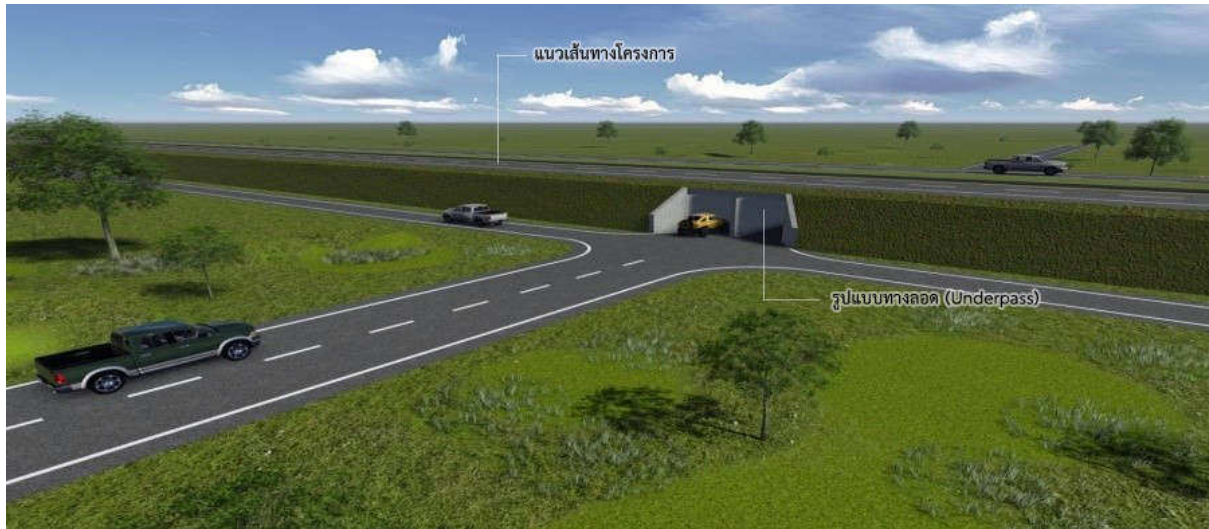
รูปที่ 2.1.1-9 รูปแบบทางลอด (Underpass) โครงการทางหลวงพิเศษระหว่างเมือง สายบางใหญ่-กาญจนบุรี ที่เสนอไว้ในรายงานการประเมินผลกระทบสิ่งแวดล้อม
