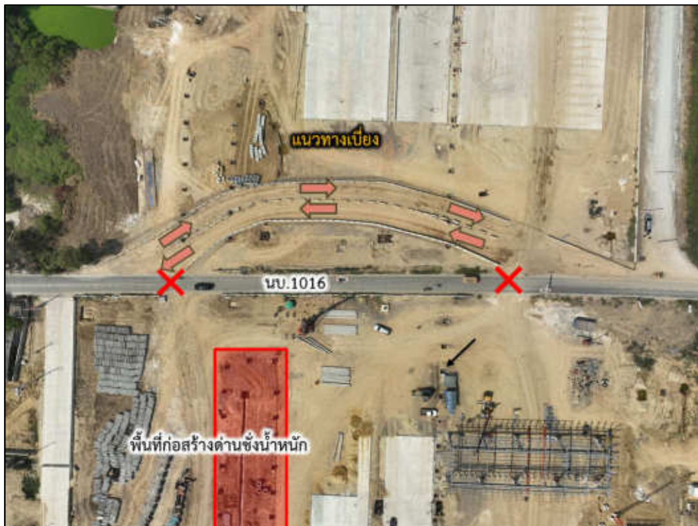
รูปที่ 5.2.7-2 ทางเบี่ยงชั่วคราวเพื่อหลบพื้นที่ก่อสร้างด้านเก็บค่าผ่านทางบางใหญ่
