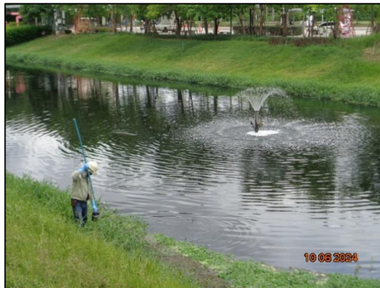
รูปที่ 3.3 การเก็บตัวอย่างคุณภาพน้ำผิวดิน บริเวณจุดก่อนระบายน้ำ ระยะ 50 เมตร
