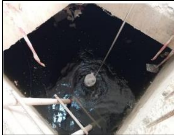
รูปที่ 3.4-2 การเก็บตัวอย่างคุณภาพน้ำ บริเวณบ่อพักน้ำพร้อมตะแกรงดักขยะ ก่อนระบายออกสู่ท่อระบายน้ำริมถนนพญาไทด้านหน้าโครงการ
