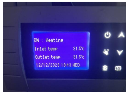
ภาพที่ 34 เทอร์โมสต์ชนิดอิเล็กทรอนิกส์
