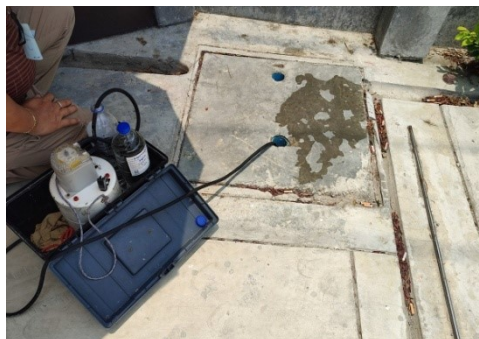
ภาพที่ 10-9 ฝาบ่อตรวจสอบคุณภาพน้ำทั้งเป็นฝาคอนกรีต และเก็บตัวอย่างตรวจสอบคุณภาพน้ำทั้งทุกเดือน
