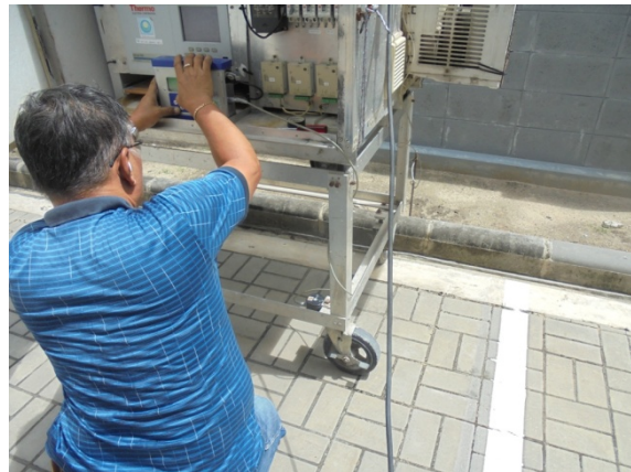
ติดตั้งเครื่องตรวจวัดฝุ่นละออง แบบ Gravimetric method , เครื่องตรวจวัดระดับเสียง Integrating Sound Level meter และเครื่องวัดแรงสั่นสะเทือน ภายในพื้นที่โครงการ ติดตั้งเครื่องวัดก๊าซมลพิษภายในพื้นที่โครงการ CO , NO 2 , SO 2 , THC
