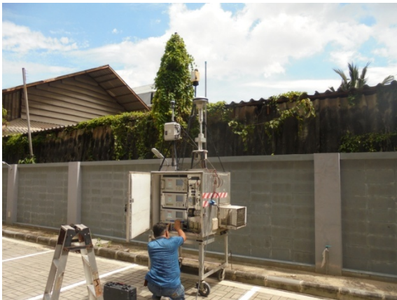
ติดตั้งเครื่องตรวจวัดฝุ่นละออง แบบ Gravimetric method , เครื่องตรวจวัดระดับเสียง Integrating Sound Level meter และเครื่องวัดแรงสั่นสะเทือน ภายในพื้นที่โครงการ ติดตั้งเครื่องวัดก๊าซมลพิษภายในพื้นที่โครงการ CO , NO 2 , SO 2 , THC
