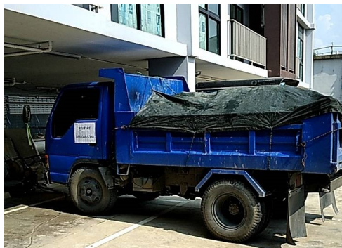
ภาพที่ 6-6 ปิดคลุมท้ายกระบะบรรทุกทุกครั้งที่มีการขนส่งวัสดุอุปกรณ์
