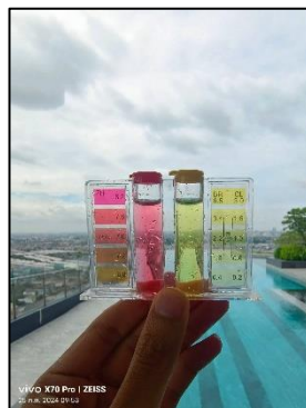
รูปที่ 47 การตรวจสอบคุณภาพน้ำ pH และ Residual Chlorine
