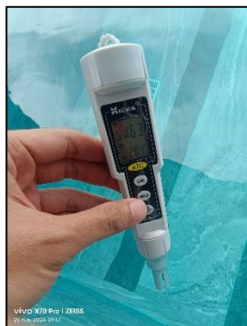
รูปที่ 47 การตรวจสอบคุณภาพน้ำ pH และ Residual Chlorine
