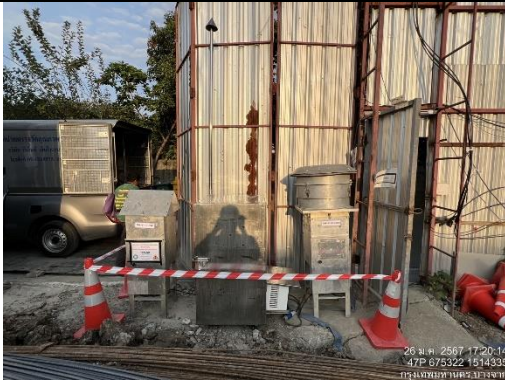
รูปที่ 6 ติดตั้งเครื่องตรวจวัดคุณภาพอากาศ (TSP, PM10, CO, NO 2 , SO 2 และ THC)
