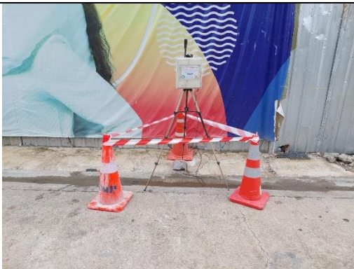
รูปที่ 7 ติดตั้งเครื่องตรวจวัดระดับเสียงและความสั่นสะเทือน
