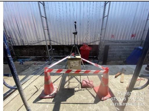
รูปที่ 7 ติดตั้งเครื่องตรวจวัดระดับเสียงและความสั่นสะเทือน
