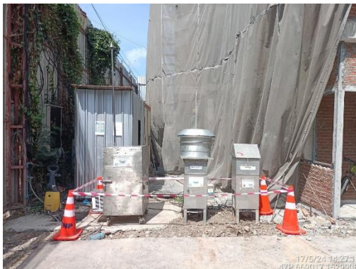
รูปที่ 15 ติดตั้งเครื่องตรวจวัดคุณภาพสิ่งแวดล้อม (คุณภาพอากาศ ระดับเสียง และความสั่นสะเทือน)
