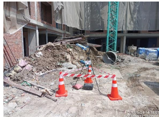
รูปที่ 15 ติดตั้งเครื่องตรวจวัดคุณภาพสิ่งแวดล้อม (คุณภาพอากาศ ระดับเสียง และความสั่นสะเทือน)
