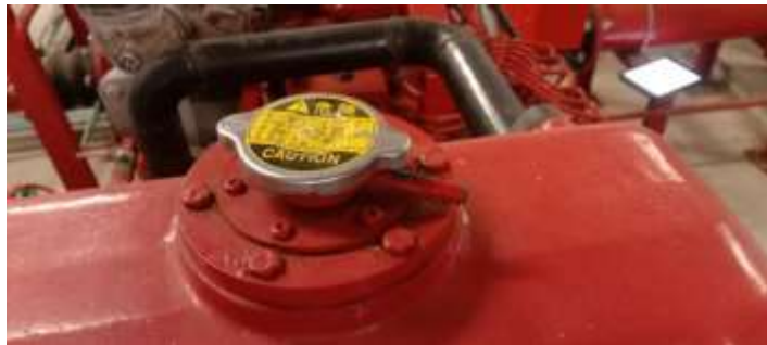
รูปที่ 14 ตรวจเช็คฝาปิดหม้อน้ำ
