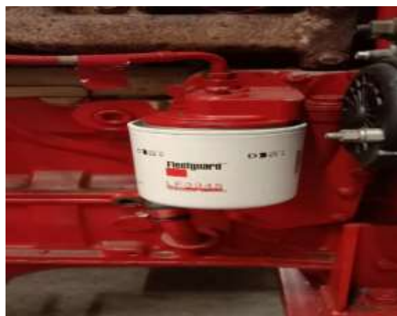
รูปที่ 8 ตรวจเช็คตัวกรองน้ำมันกรองน้ำมันโซล่า
